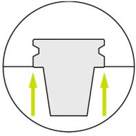
刀柄與主軸的端面接觸和AT1的錐度精度，達到最佳的剛性
